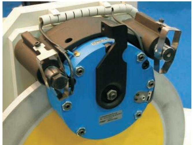
**Bild 1: Die ROBA®-diskstop® ist äußerst robust und zuverlässig. Eine patentierte Freistellung sorgt dafür, dass die Bremsscheibe im Betrieb schleiffrei zwischen den Reibbelägen läuft. Die Bremse arbeitet mit einem relativ großen Luftspalt und ist mit einem hochwirksamen patentierten Geräuschdämpfungssystem ausgestattet, das die Schaltgeräusche auch bei Belagverschleiß und dadurch zunehmendem Luftspalt gering hält.**
